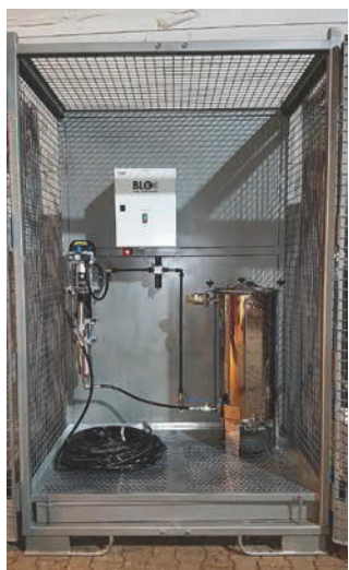
Härter-Unit ist ausgerüstet mit 100-Liter-Edelstahlbehälter.
