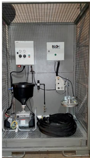
Die 1K-Anlagen-Unit HD-Doppelmembranpumpe kommt bei Sonderaufgaben zum Einsatz.
