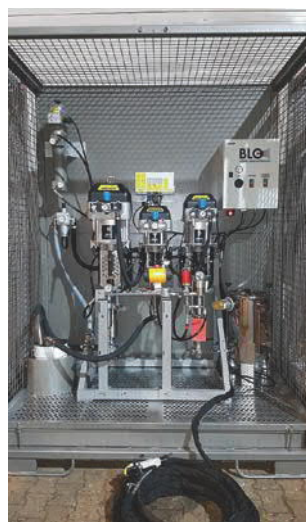
Die 2K-Anlagen-Unit ermöglicht die Verarbeitung der Lackkomponenten, die per Förderpumpen zugeführt oder wahlweise aus 30-Liter-Hobbocks verarbeitet werden.
