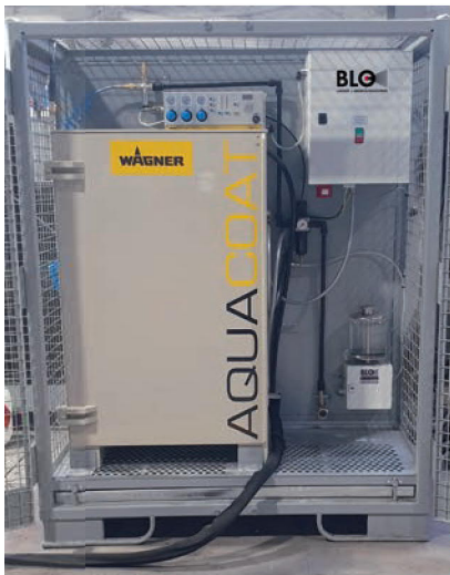
Wasserlack-Unit zur Schiffsinnenbeschichtung verfügt über eine Esta-Anlage.
