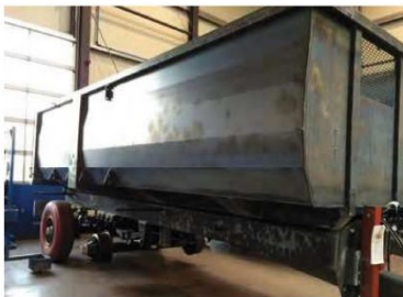
Die geschwungenen und phosphatierten Wannen (li.) erstrahlen nach dem Beschichten mit dem Einschicht-Lacksystem in der Hausfarbe Rot (re.)
