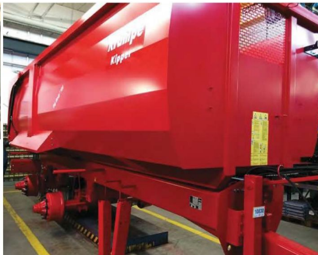
Die geschwungenen und phosphatierten Wannen (li.) erstrahlen nach dem Beschichten mit dem Einschicht-Lacksystem in der Hausfarbe Rot (re.)
